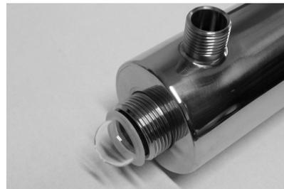
**Шаг 8:** Закрутите руками заглушенный фиксатор кварцевой трубки со стороны её закрытого конца. Не затягивайте очень сильно, чтобы не повредить уплотнительное кольцо.
