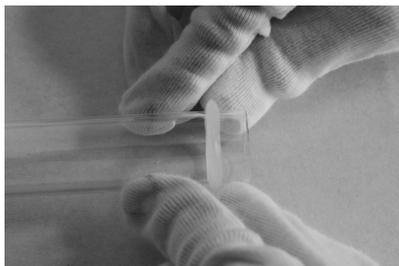
**Шаг 6:** Установите кварцевую трубку в камеру реактора.
