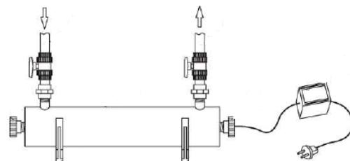
**Шаг 14:** После присоединения системы к водопроводу, медленно включите подачу воды и проверьте на наличие протечек.
