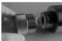
**Шаг 9:** Закрутите руками сквозной фиксатор кварцевой трубки со стороны её открытого конца. Не затягивайте очень сильно, чтобы не повредить уплотнительное кольцо.
