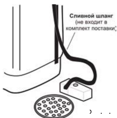
Рис. 6 Установка дренажного шланга
