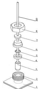
Рис.3. Схема сборки узла УФ датчика.
